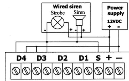
ADVERTENCIA: Nunca conecte la salida "S" del receptor directamente a la alimentación positiva de la fuente (+VDC).
