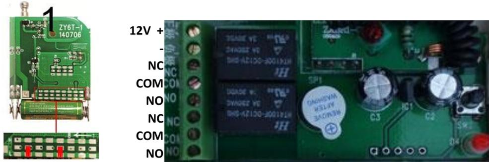
**Método de aprendizaje:** Presione la tecla de aprendizaje en el receptor, presione inmediatamente cualquier botón en el transmisor, después de recibir la señal del receptor, el parpadeo del LED indica un aprendizaje exitoso. Por ejemplo :
