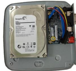
③ Coloque el HDD correctamente conforme a los cuatro orificios de su parte inferior.
