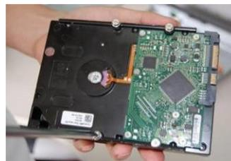
② Coloque cuatro tornillos en el HDD (gírelos solo tres vueltas).
