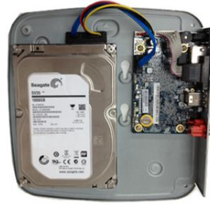
⑥ Conecte el cable de datos y el cable de alimentación del HDD.
