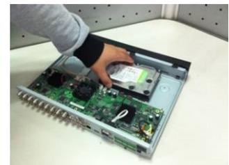
③ Coloque el HDD correctamente conforme a los cuatro orificios de su parte inferior.
