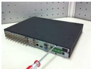
① Afloje los tornillos de la tapa superior y del panel lateral.
